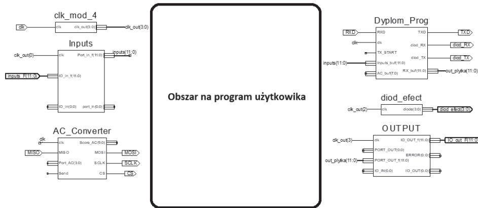
Rys. 5. Okno programu odzwierciedlające strukturę sprzętową sterownika
